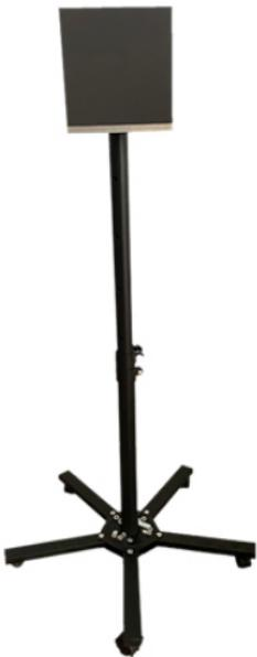
瑞科光电激光雷达定标板应用介绍：激光雷达的性能直接决定了ADAS和无人驾驶系统的性能。激光雷达，简称LiDAR（即光探测与测量，是一种集激光、全球定位系统和IMU三种技术于一身的系统，用于获得数据并生成精确的DEM（数字高程模型）。这三种技术的结合，可以高度准确地定位激光束打在物体上的光斑，测距精度可达厘米级，激光雷达较大的优势就是“准确”和“快速、高效作业”。LiDAR通过测量激光信号的时间差、相位差确定距离，通过水平旋转扫描或相控扫描测角度，并根据这两个数据建立二维的极坐标系；再通过获取不同俯仰角度的信号获得第三维的高度信息。高频激光可在一秒内获取大量（ $10^6$ - $10^7$ 数量级）的位置点信息（称为点云），并根据这些信息进行三维建模。除了获得位置信息外，它还可通过激光信号的反射率初步区分不同材质。
